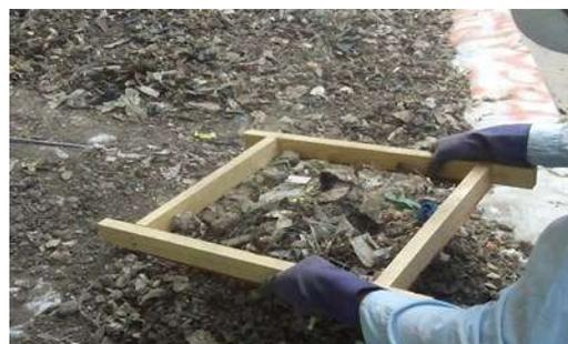
**Figura 7.** Cribado de los residuos estabilizados
